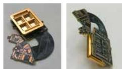
Laser Lötmontage eines LiDAR-Sensors auf PCB über THT Kontakte
